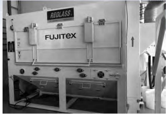
写真2 カバーガラス剥離装置（プラスト式）
