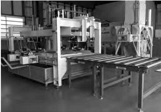
写真1 フレーム外し装置
