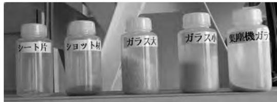
写真3 剥離後のガラス、投射材、シリコン等
