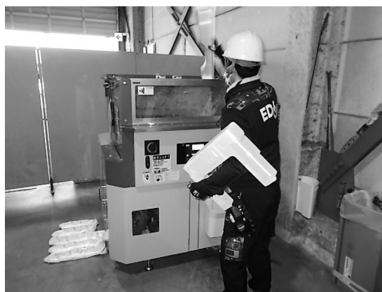
写真2 発泡スチロールを溶解減容処理する様子
