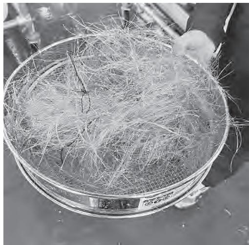
写真1 切断、洗浄後の漁網
