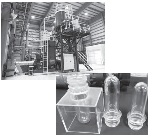
東日本 F to P ファクトリーのプリフォームをダイレクトに成型するプラントと成型されたプリフォーム (左の四角は展示台)
