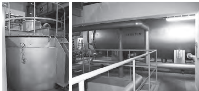
左:①予備処理タンク 右:②油温減圧式脱水乾燥装置(クッカー)
