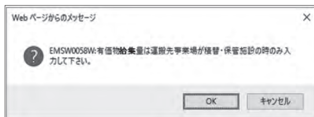
図6 積替・保管施設を経由しないマニフェストで有価物拾集量を入力した場合の警告画面
