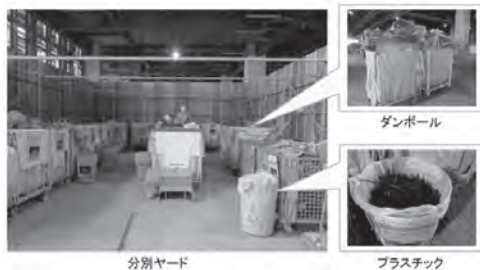
写真1. 建設現場から排出される再生資源
